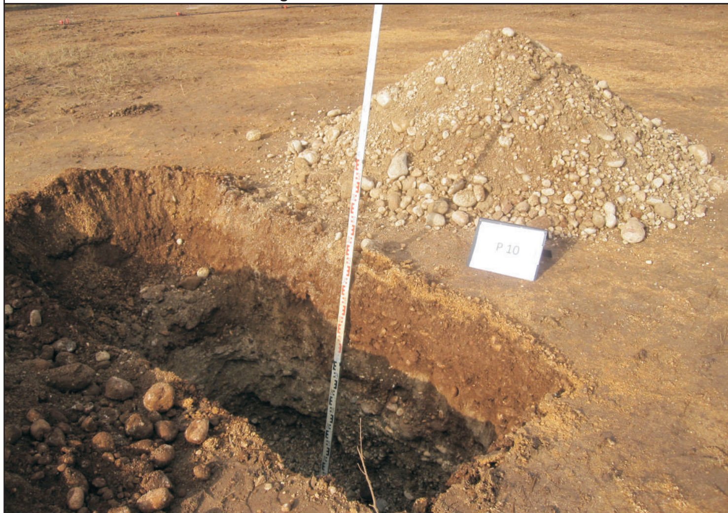
Vista d'insieme della sezione stratigrafica relativa alla trincea esplorativa n.10 e litologia rinvenuta durante lo scavo
