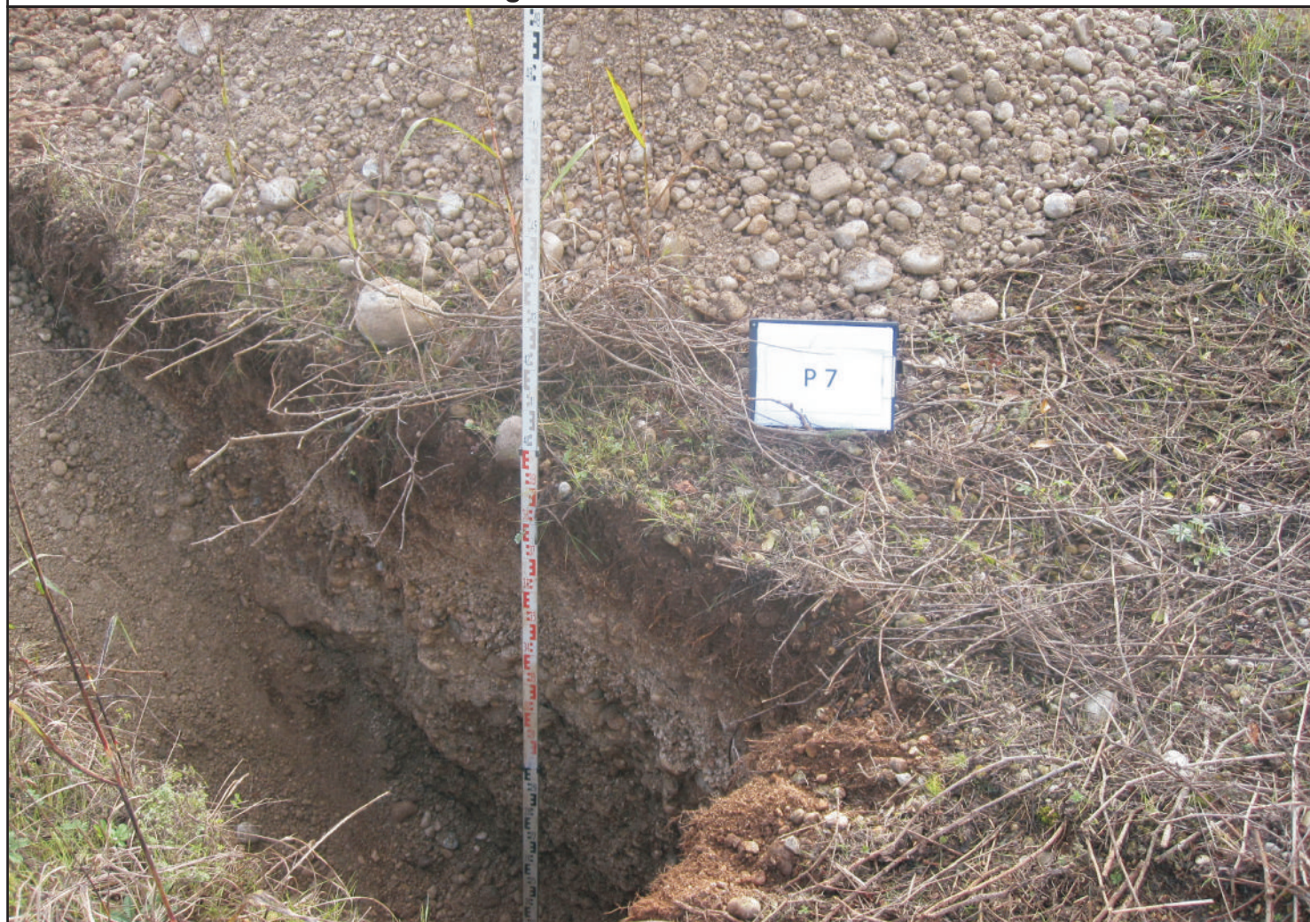
Vista d'insieme della sezione stratigrafica relativa alla trincea esplorativa n.7 e litologia rinvenuta durante lo scavo
