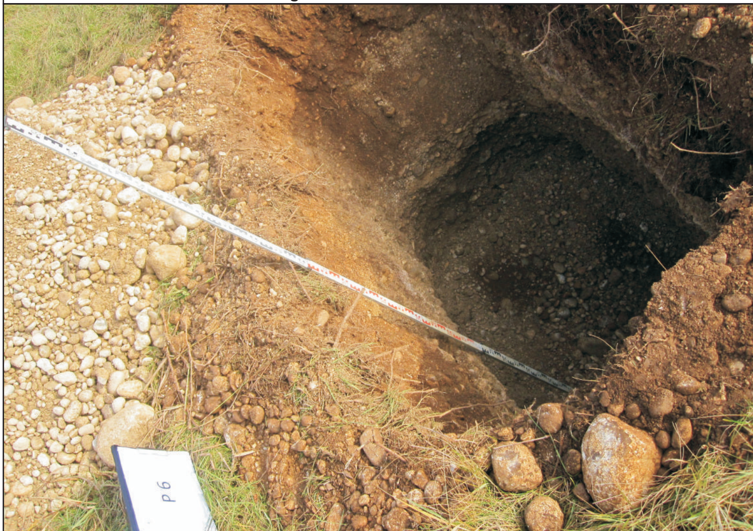
Vista d'insieme della sezione stratigrafica relativa alla trincea esplorativa n.6 e litologia rinvenuta durante lo scavo
